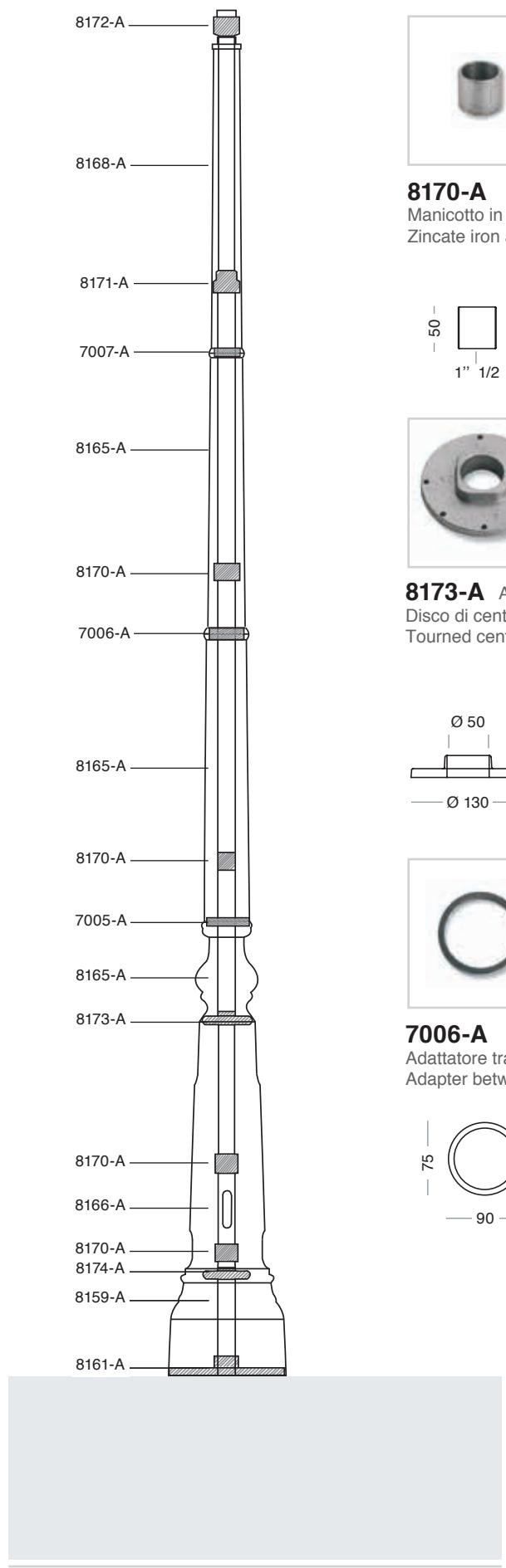
Struttura interna Palo - Internal pole structure
